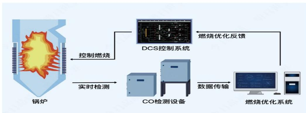
图 6 工艺流程图
